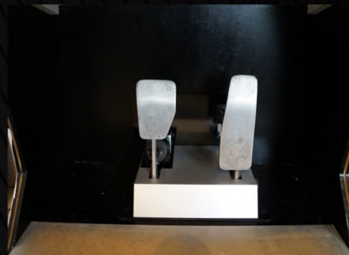
Ανακατασκεύασα τα πεντάλ γκαζιού και φρένου. Τα έβαψα στο αρχικό τους χρώμα. Έλειπε και ένα ελατήριο, βρήκα ένα ίδιο σε ένα μαγαζί με ελατήρια.
