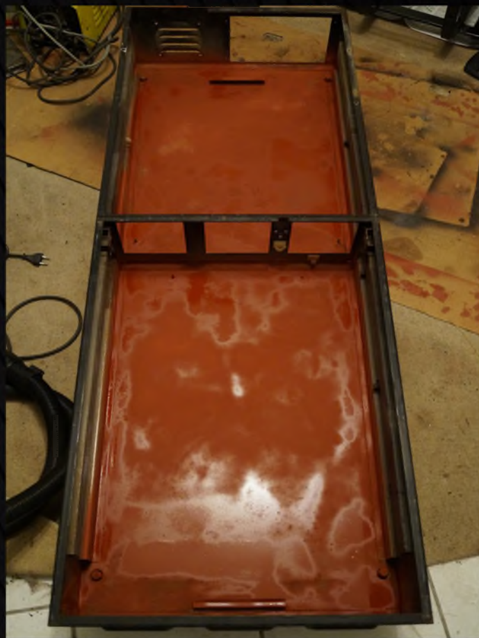
Η βάση φρεσκοβαμμένη με αντισκωριακό χρώμα εσωτερικά.
