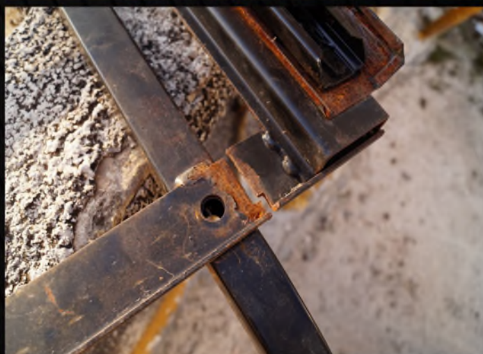
Ακόμη και η μεταλλική βάση του καθίσματος ήταν σπασμένη σε ένα σημείο όπως φαίνεται στην φωτογραφία.
