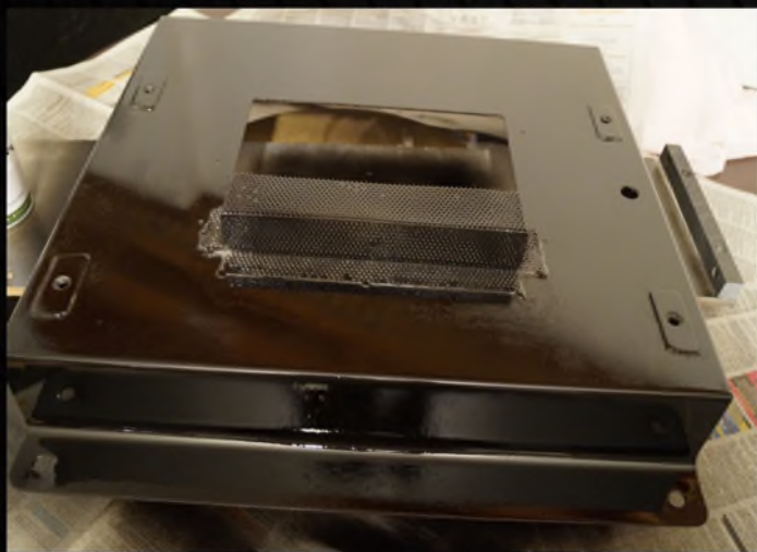
Και εδώ είναι φρεσκοβαμμένη, αφού βέβαια πρώτα πέρασα 2 χέρια αστάρι.
