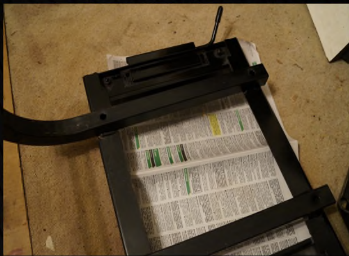
Κόλλησα στην βάση του καθίσματος με ηλεκτροκόλληση το σπασμένο σημείο και μετά την έβαψα στο μαύρο χρώμα.
