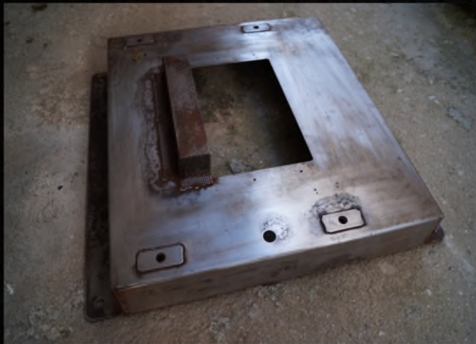
Η βάση του καθίσματος με την υποδοχή του sub, κατά την διάρκεια της αφαίρεσης του χρώματος.
