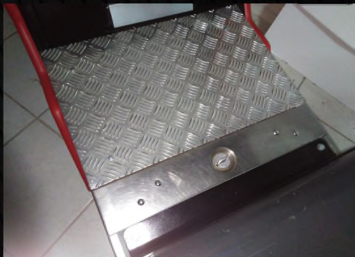
Το πάνελ τύπου "κριθαράκι" βιδωμένο στο πάτωμα.
